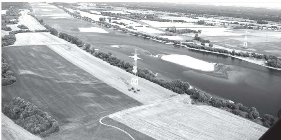
Fot. 2. Uregulowany w II poł XIX w. odcinek Wisły poniżej Torunia z licznymi łachami centralnymi — naprzemianległymi (wcześniej skośnymi 23 ), które aktualnie w tym miejscu stanowią końcowy fragment odcinka akumulacyjnego (ryc. 1 Ab), fot. 17 VIII 2015 r.
